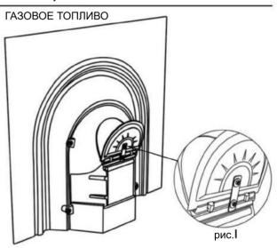
Использование твердого топлива: вставьте заслонку в пазы с обратной стороны топливника. Использование газового топлива: заслонка всегда должна быть открыта. Для этого используйте набор деталей для крепежа заслонки. Навинтите гайку М6 полностью на болт М6 и только затем 2 шайбы М6. Зафиксируйте пластину для крепления заслонки как изображено на рис.1
