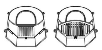
Вставьте колосник в пазы топливника. Закрепите и затяните с помощью гайки, болта и шайбы М6.
