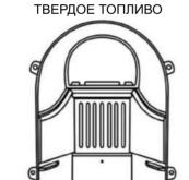
В случае использования газового топлива не снимать удерживающую пластину огнеупорного камня. Переходите сразу к п.3. В случае использования твердого топлива снимите удерживающую пластину огнеупорного камня с лицевой стороны
