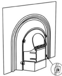
Прикрепите топливник сзади портала, убедившись что гайки М6 проходят через крепежные скобы с обратной стороны топливника. Закрепите и затяните используя 4 шайбы и 4 гайки М6.
