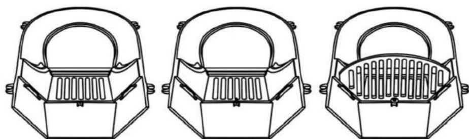
Положите топливник на ровную поверхность. Поместите оgneупорный камень на место и затем вставьте болт в отверстие прямо под ним. Вставьте колосник в пазы дровника над гайкой M6. Закрепите с помощью шайбы M6 и болта M6.
