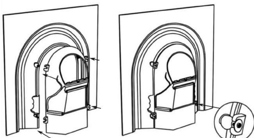
Прикрепите топливник сзади портала, убедившись что гайки M6 проходят через крепежные скобы с обратной стороны топливника. Закрепите и затяните используя 4 шайбы и 4 гайки M6.
