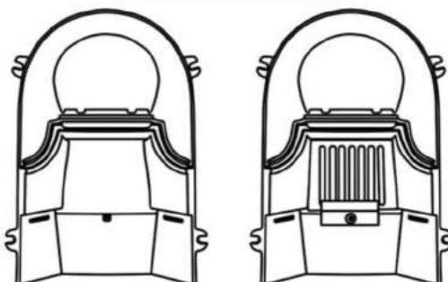
Поместите оgneупорный камень на место и прикрепите, используя удерживающую пластину оgneупорного камня, закрепите с помощью винта, шайбы, и болта M6.
