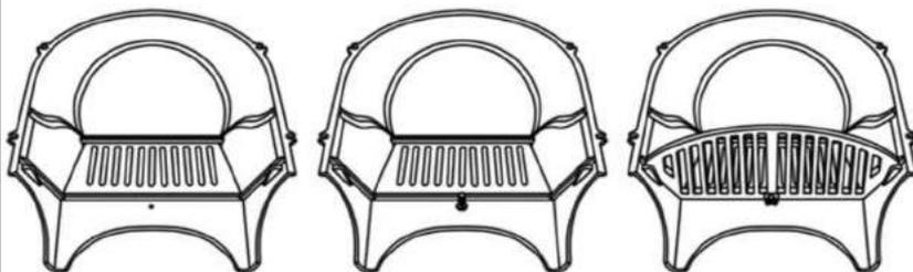
Вставьте колосник в пазы дровника. Закрепите и затяните с помощью шайбы М6 и болта М6.
