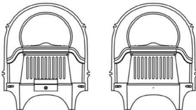
В случае использования газового топлива не снимать удерживающую пластину огнеупорного камня. Переходите сразу к п.3
