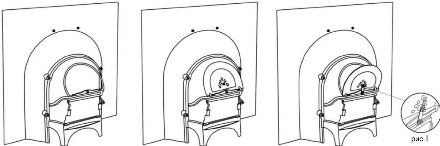
Использование твердого топлива: вставьте заслонку в пазы с обратной стороны топливника.
