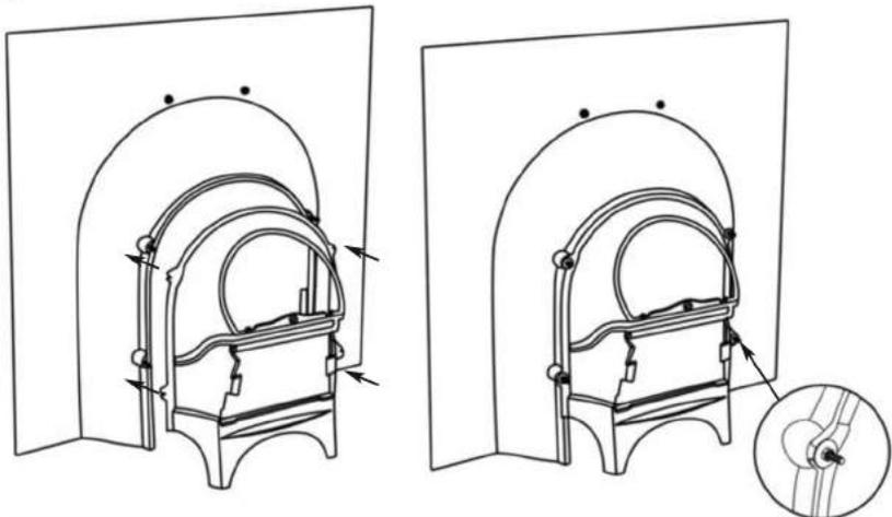
Прикрепите топливник сзади портала, убедившись что гайки М6 проходят через крепежные скобы с обратной стороны топливника. Закрепите и затяните используя 4 шайбы и 4 гайки М6.
