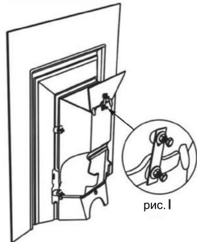
Использование твердого топлива: вставьте заслонку в пазы с обратной стороны топливника.
