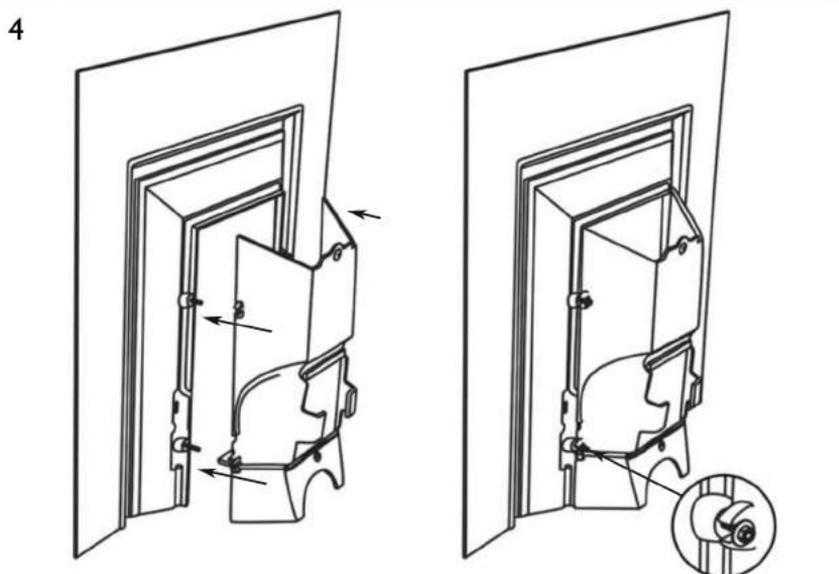
Прикрепите топливник сзади портала, убедившись что гайки М6 проходят через крепежные скобы с обратной стороны топливника. Закрепите и затяните используя 4 шайбы и 4 гайки М6.
