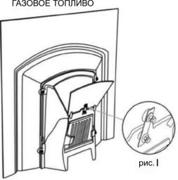
Использование твердого топлива: вставьте заслонку в пазы с обратной стороны топливника. Использование газового топлива: заслонка всегда должна быть открыта. Для этого используйте набор деталей для крепежа заслонки. Вставьте болт М6 в отверстие сзади заслонки на задней стороне камина, приложите крепящую пластину для заслонки и закрепите болтом М6 (рис.1).
