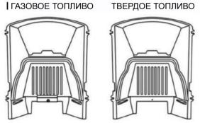
Поместите огнеупорный камень на место и прикрепите, используя удерживающую пластину огнеупорного камня, закрепите с помощью винта, шайбы, и болта М6.
