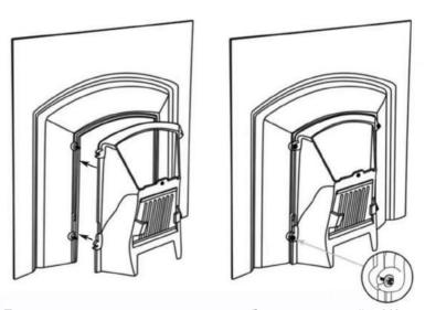
Прикрепите топливник сзади портала, убедившись что гайки М6 проходят через крепежные скобы с обратной стороны топливника. Закрепите и затяните используя 4 шайбы и 4 гайки М6.
