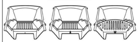
Положите топливник на ровную поверхность. Поместите огнеупорный камень на место и затем вставьте болт в отверстие прямо под ним. Вставьте колосник в пазы дровника над гайкой М6. Закрепите с помощью шайбы М6 и болта М6.
