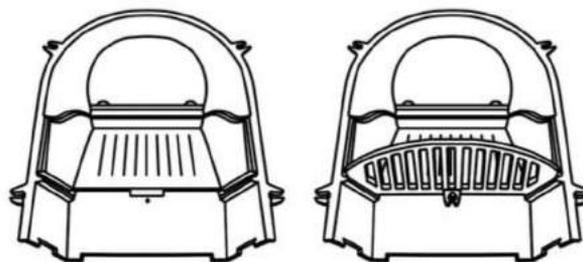
Вставьте колосник в пазы топливника. Закрепите и затяните с помощью гайки, болта и шайбы М6.
