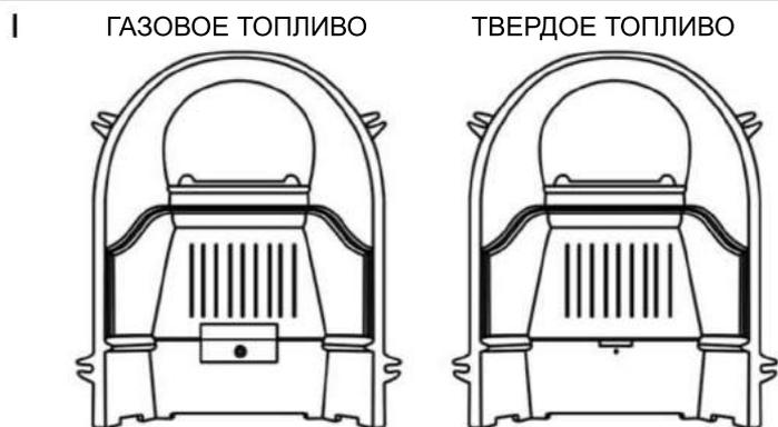
В случае использования газового топлива не снимать удерживающую пластину огнеупорного камня. Переходите сразу к п.3
