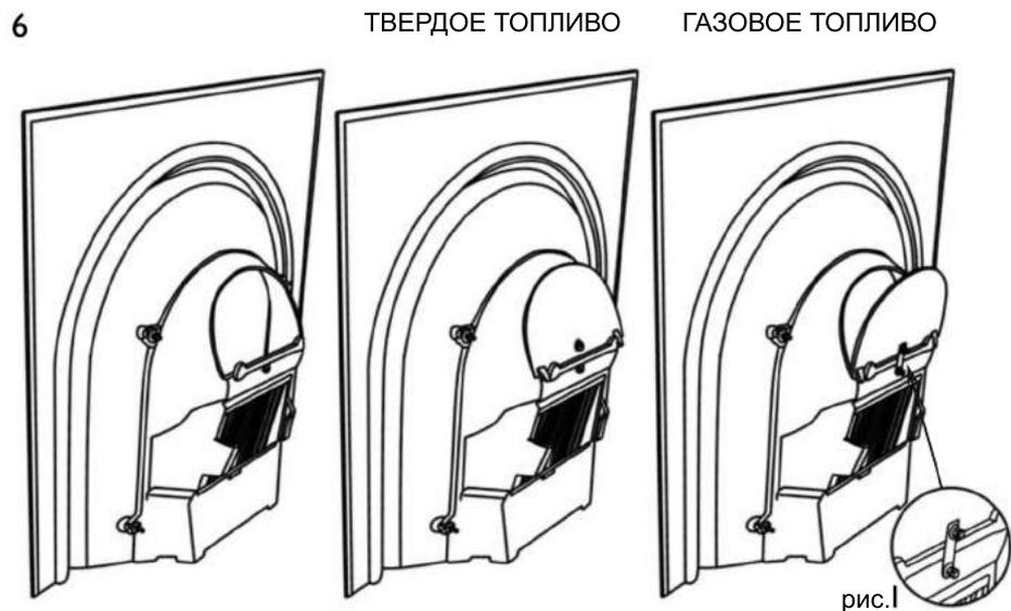
Использование твердого топлива: вставьте заслонку в пазы с обратной стороны топливника.
