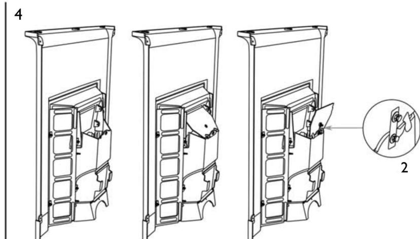
Использование твердого топлива: вставьте заслонку в пазы с обратной стороны топливника. При горении дров заслонка всегда должна быть открыта. Для этого используйте набор деталей для крепежа заслонки. Навинтите гайку M6 полностью на болт M6 и только затем 2 шайбы M6. Зафиксируйте пластину для крепления заслонки как изображено на рис.2
