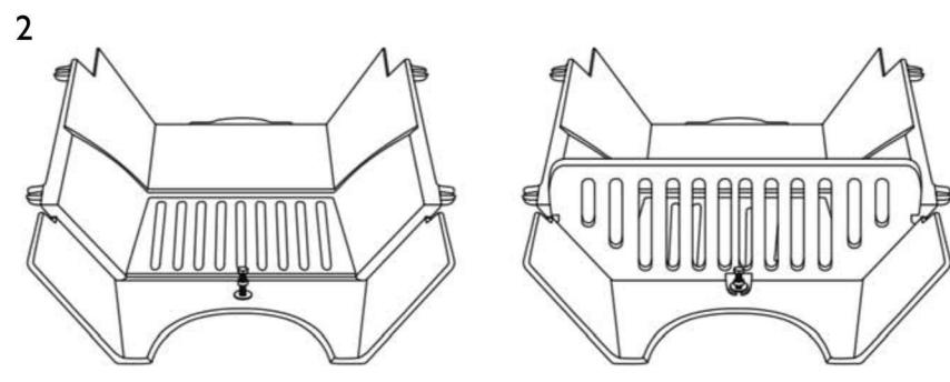
Положите топливник на ровную поверхность. Поместите огнеупорный камень на место и затем вставьте болт в отверстие прямо под ним. Вставьте колосник в пазы дровника над гайкой M6. Закрепите с помощью шайбы M6 и болта M6.
