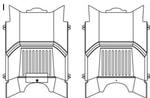
Снимите удерживающую пластину огнеупорного камня, удалив крепление M6. В случае использования твердого топлива этот шаг не требуется.
