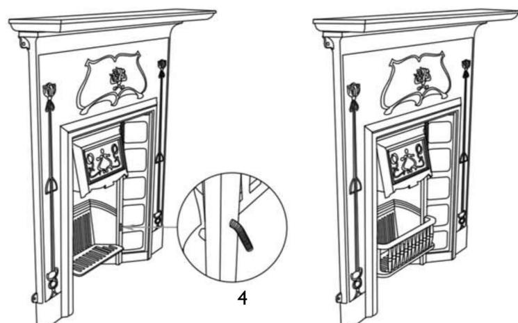
Зафиксируйте 2 крепежные шпильки с обратной стороны декоративной решетки (рис.4).
