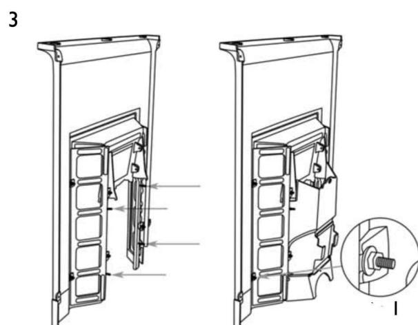
Вставьте 4 гайки M6 с обратной стороны портала. Прикрепите топливник сзади портала, убедившись что гайки M6 проходят через крепежные скобы с обратной стороны топливника. Закрепите и затяните используя 4 шайбы и 4 гайки M6.
