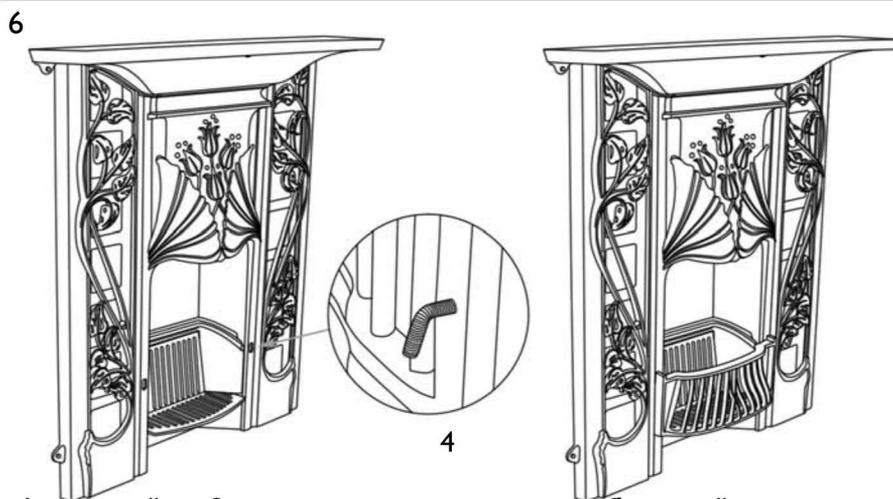
Зафиксируйте 2 крепежные шпильки с обратной стороны декоративной решетки (рис.4). Прикрепите декоративную решетку к дровнику с помощью двух крепежных шпилек.
