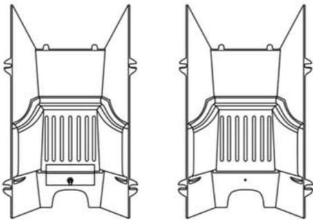
Снимите удерживающую пластину огнеупорного камня, удалив крепление M6. В случае использования твердого топлива этот шаг не требуется.
