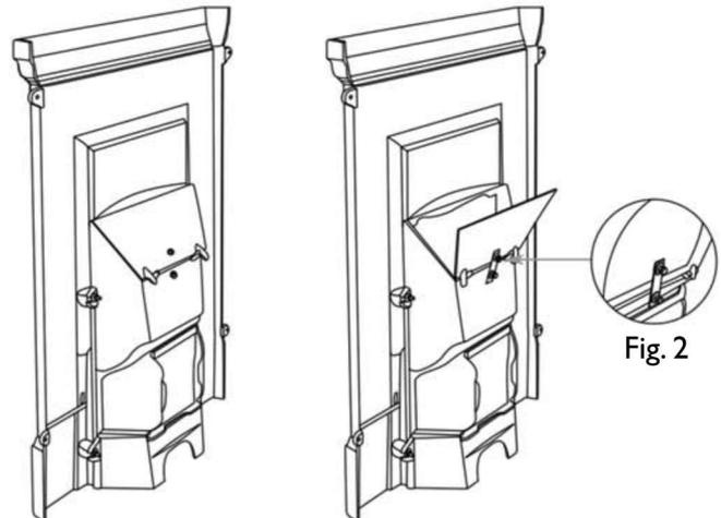
Использование твердого топлива: вставьте заслонку в пазы с обратной стороны топливника. При горении дров, заслонка всегда должна быть открыта. Для этого используйте набор деталей для крепежа заслонки. Навинтите гайку M6 полностью на болт M6 и только затем 2 шайбы M6. Зафиксируйте пластину для крепления заслонки как изображено на рис.2
