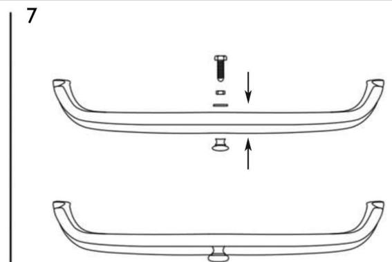
Зафиксируйте 2 крепежные шпильки с обратной стороны декоративной решетки (рис.4).
