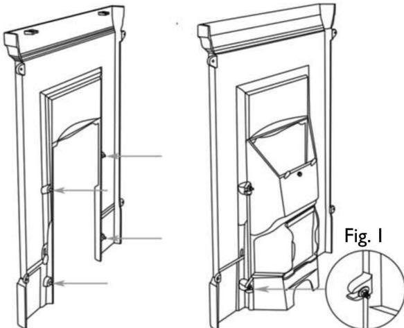
Вставьте 3 гайки M6 с обратной стороны портала. Прикрепите топливник сзади портала, убедившись что гайки M6 проходят через крепежные скобы с обратной стороны топливника. Закрепите и затяните используя 3 шайбы и 3 гайки M6.
