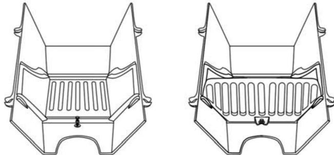
Положите топливник на ровную поверхность. Поместите огнеупорный камень на место и затем вставьте болт в отверстие прямо под ним. Вставьте колосник в пазы топливника над гайкой M6. Закрепите с помощью шайбы M6 и болта M6.
