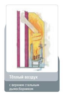
Горячий поток дымовых газов остывает в расширенной поверхности дымосборника и быстро превращаются в тёплый воздух.
