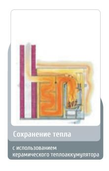
Горячий поток дымовых газов собирается чугунным куполом и формирует поток раскалённого воздуха высокой плотности. Это идеальные условия для нагрева массивных блоков керамического дымового канала,
