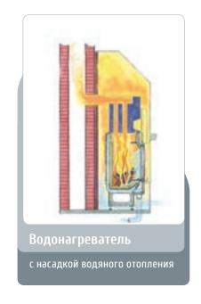
Горячие дымовые газы входят в водяной бойлер, установленный непосред-
