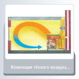
С помощью горячего воздуха много тепла может подаваться в комнату в течение короткого времени. Эта концепция часто используется, когда требуется высокая тепловая мощность (более 4 кВт), например в старых зданиях или просторных помещениях.
