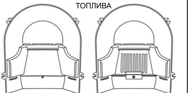
Поместите огнеупорный камень на место и прикрепите, используя удерживающую пластину огнеупорного камня, закрепите с помощью винта, шайбы, и болта М6.
