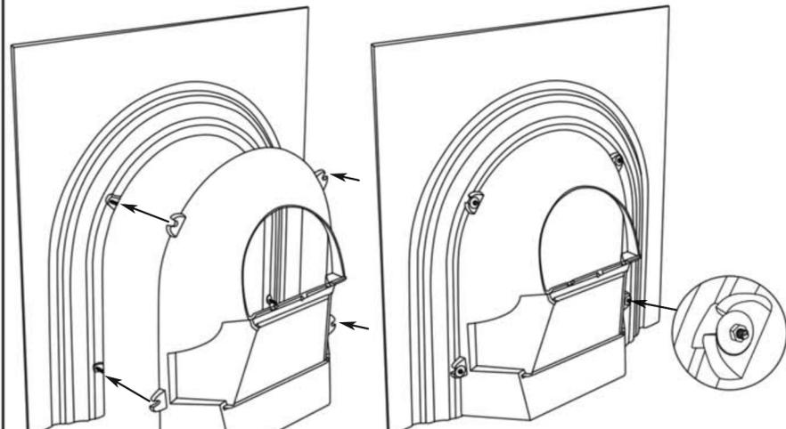
Прикрепите топливник сзади портала, убедившись что гайки М6 проходят через крепежные скобы с обратной стороны топливника. Закрепите и затяните используя 4 шайбы и 4 гайки М6.
