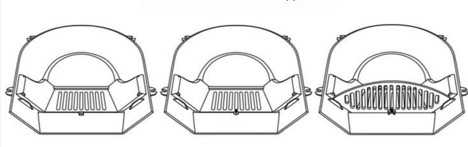
Положите топливник на ровную поверхность. Поместите огнеупорный камень на место и затем вставьте болт в отверстие прямо под ним. Вставьте колосник в пазы дровника над гайкой М6. Закрепите с помощью шайбы М6 и болта М6.
