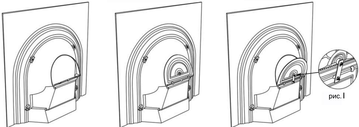
Использование твердого топлива: вставьте заслонку в пазы с обратной стороны топливника.
